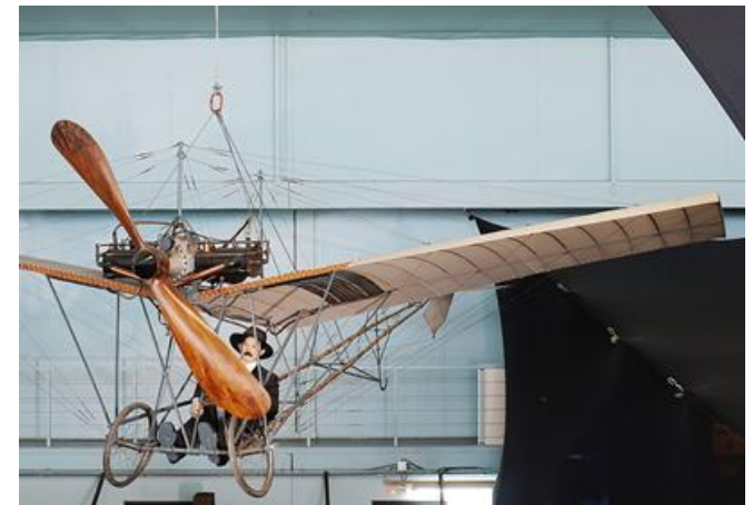
Aéroplane "Demoiselle" (photo Wikipédia) Noter le très faible allongement des ailes de forme rectangulaire, et les fortes trainées induites
